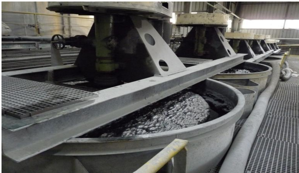
Figure 17 : Fonction d'une cellule de flottation
